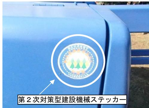
写真 8.6.1-8 排出ガス対策型建設機械の採用
