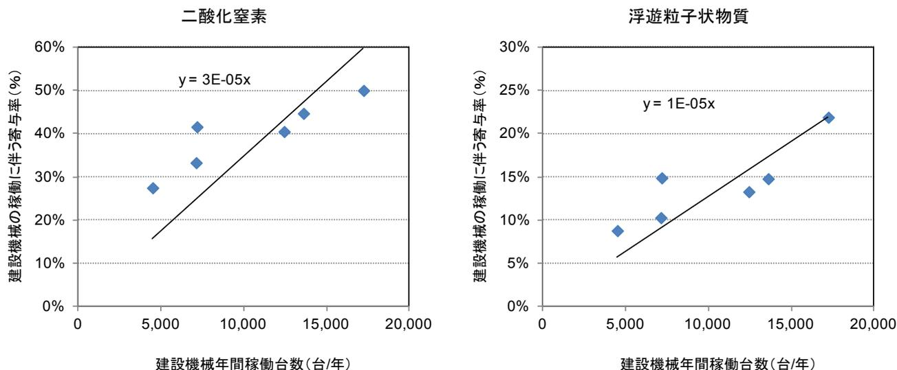
図1-1 建設機械の稼働に伴う大気汚染物質濃度の寄与率と稼働台数の関係
