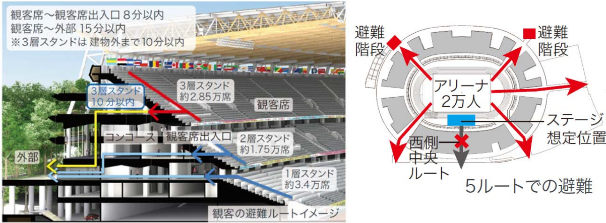
図 9. 22-7 避難シミュレーション（コンコースの滞留状況の確認）
