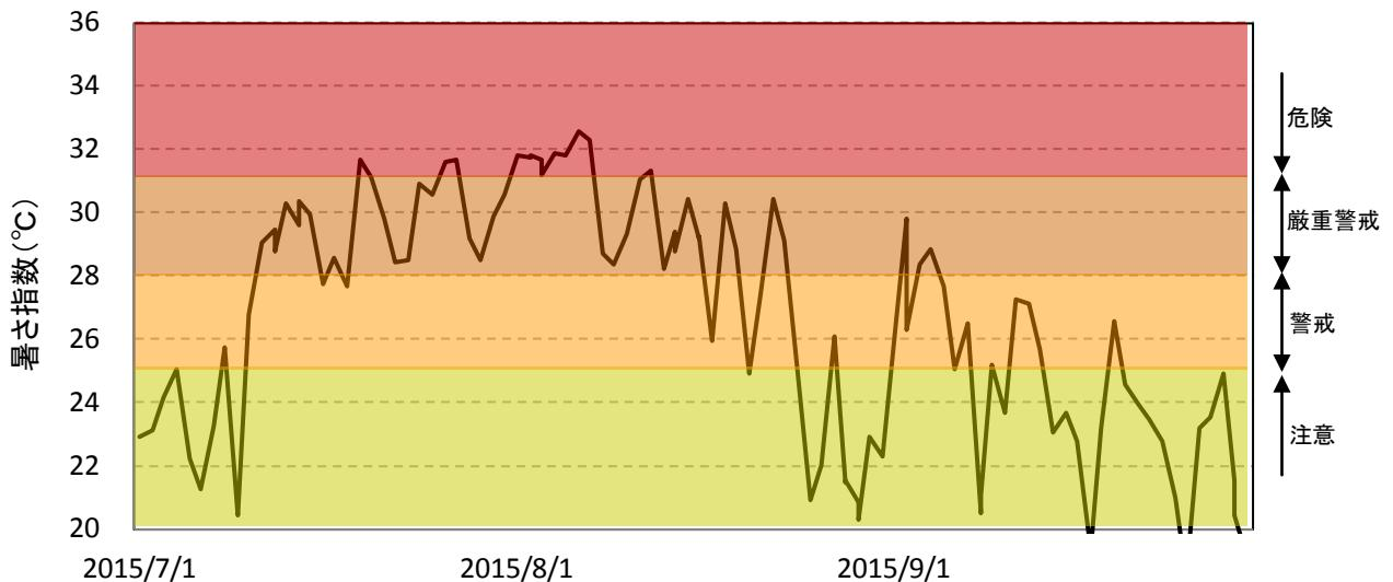
注) 暑さ指数は、東京管区気象台における気温、湿度、風速及び全天日射量を基に算出した（資料編 p. 160～p. 162 参照）。
