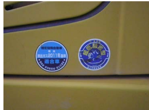
写真 6.8.4-4 排出ガス対策型、超低騒音型建設機械
