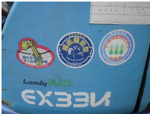
写真 6.8.4-3 排出ガス対策型、超低騒音型建設機械
