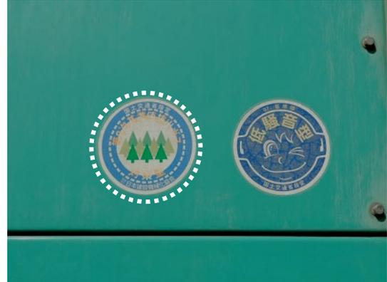
写真 8.1-6 排出ガス対策型建設機械 (第2次基準値)
