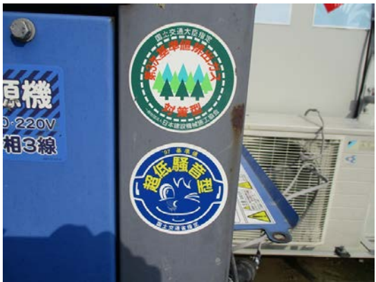
写真 8.3-4 排出ガス対策型建設機械（第3次基準値）
