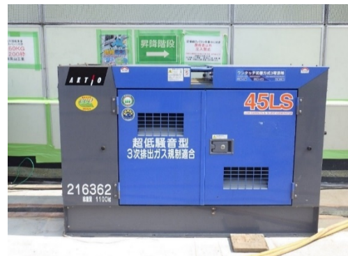
写真 8.1-16 第3次対策型建設機械
