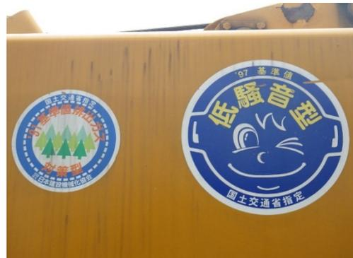
写真 8.6-6 低騒音型建設機械ステッカー
