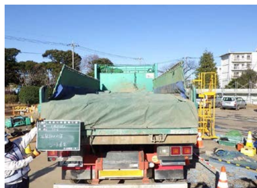
写真 8.2-2 荷台の拡散防止シート
