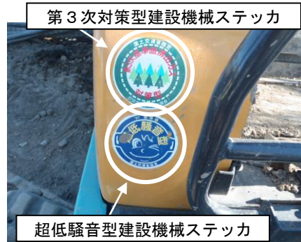
写真 8.7-2 排出ガス対策型建設機械
