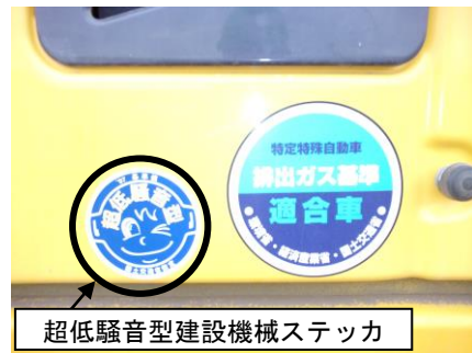
写真 8.7-8 超低騒音型建設機械
