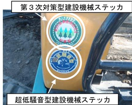
写真 8.7-2 排出ガス対策型建設機械
