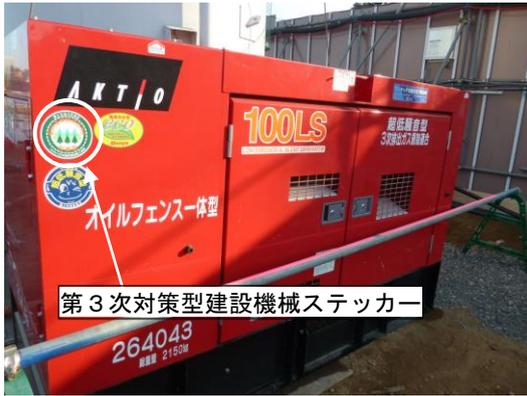
写真 8. 1-9 排出ガス対策型建設機械の採用
