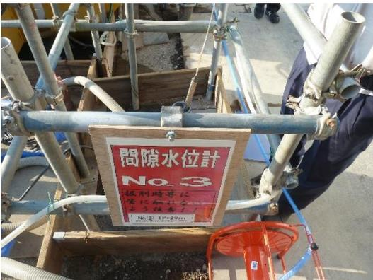
写真 8.4-3 間隙水位計
