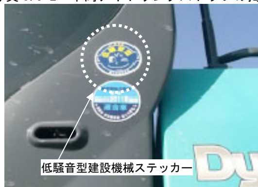
写真 8.5-4 低騒音型建設機械の採用
