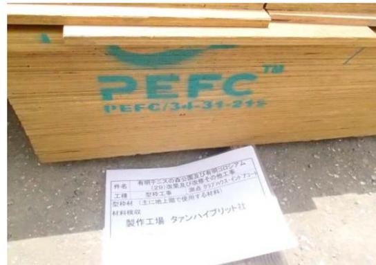
写真 8.9-6 コンクリート型枠合板
