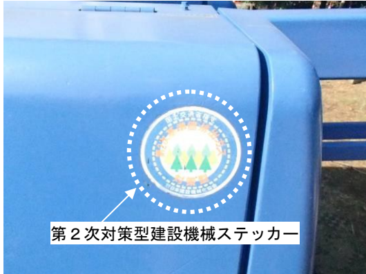
写真 8.1-9 排出ガス対策型建設機械の採用
