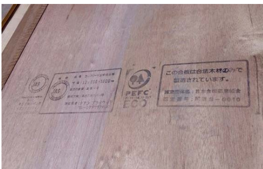
写真 8.9-7 コンクリート型枠合板
