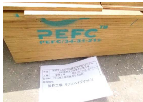
写真 8.9-6 コンクリート型枠合板
