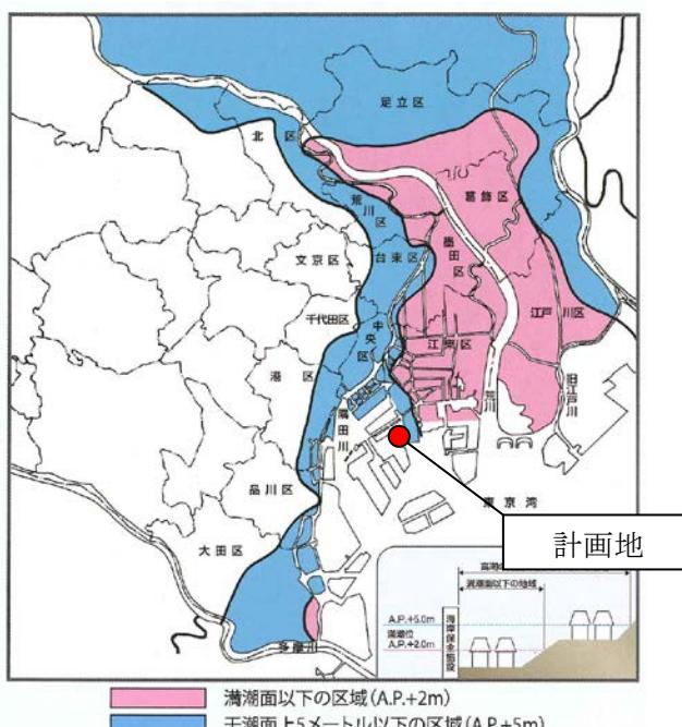
東京都の防潮堤等の整備計画は、図 9.16-2 に示すとおりであり、計画地は海岸保全区域内に位置している。東京湾の外郭防潮堤は概成しており、その外側の堤外地防潮堤と内側の内部護岸は約 7 割整備されている。また、水門は 19 箇所、排水機場は 4 箇所整備されている。なお、外郭防潮堤の未整備部分は、想定される高潮の高さより、地盤が高い場所などに位置している。計画地の北～北東部の沿岸は、堤外地防潮堤（有明北地区）にあたり、高潮・津波対策のための防潮堤（津波の想定レベル T.P. +2.5m に対して、防潮堤頂部は約 T.P. +5m）となっている。
