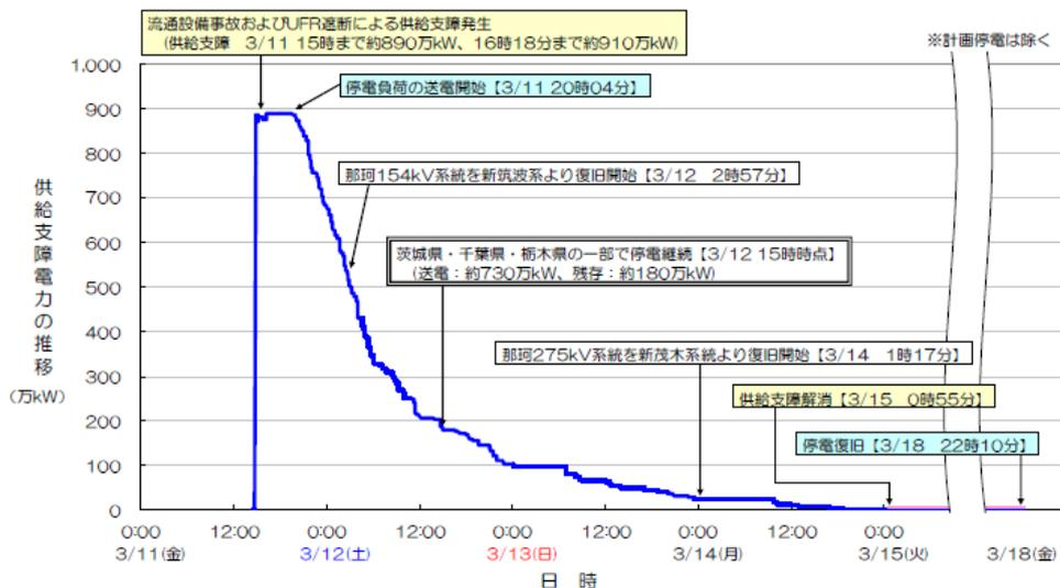
図9.12-2 東日本大震災による東京電力（株）エリアにおける停電の推移
