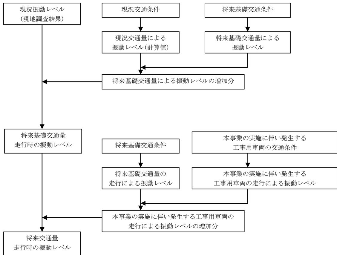
図 9.5-5 工事用車両の走行に伴う道路交通振動の予測手順
