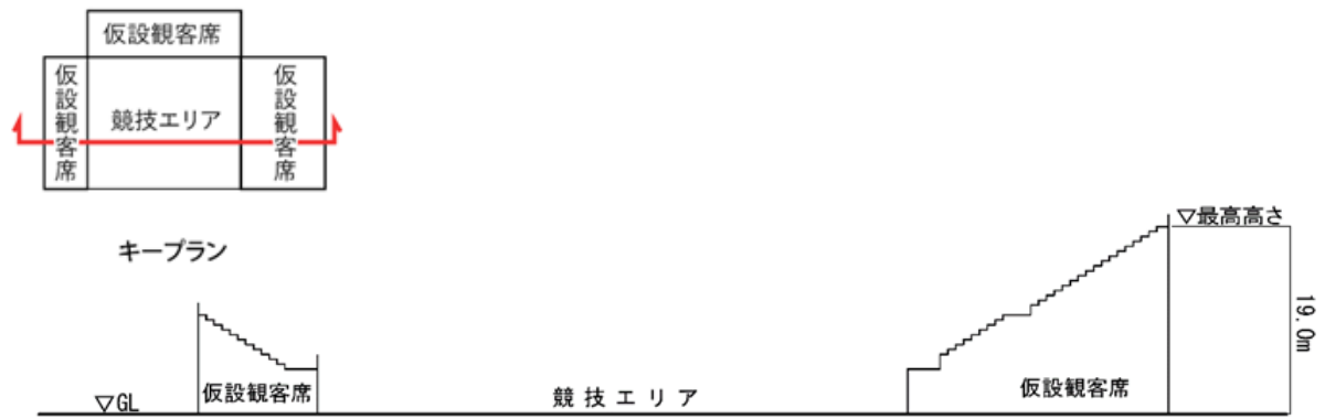
図 4.2-4(1) 断面図 (自転車競技 (BMX フリースタイル))
