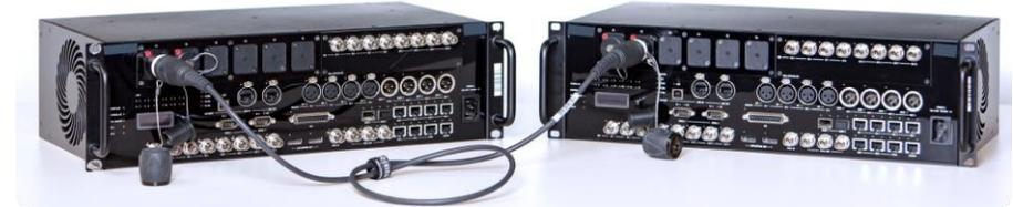
従来の各機器を1対1で接続していた構成から、DIVAネットワークとして統合してケーブル敷設を行う
